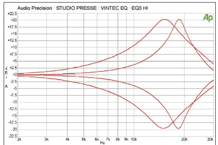
Diagramm 5: Hi Band: nominale Ansatzfrequenzen 10 kHz und 20 kHz, Gain auf Minimum und Maximum
