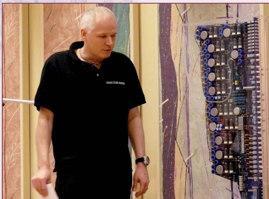
In der Everest C3-Konsole arbeiten sage und schreibe 1.660 sorgfältig selektierte Doppeltrioden.
